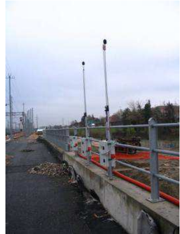
Figura 2 - Fotografia aerea e particolare della centralina di monitoraggio fonometrico
