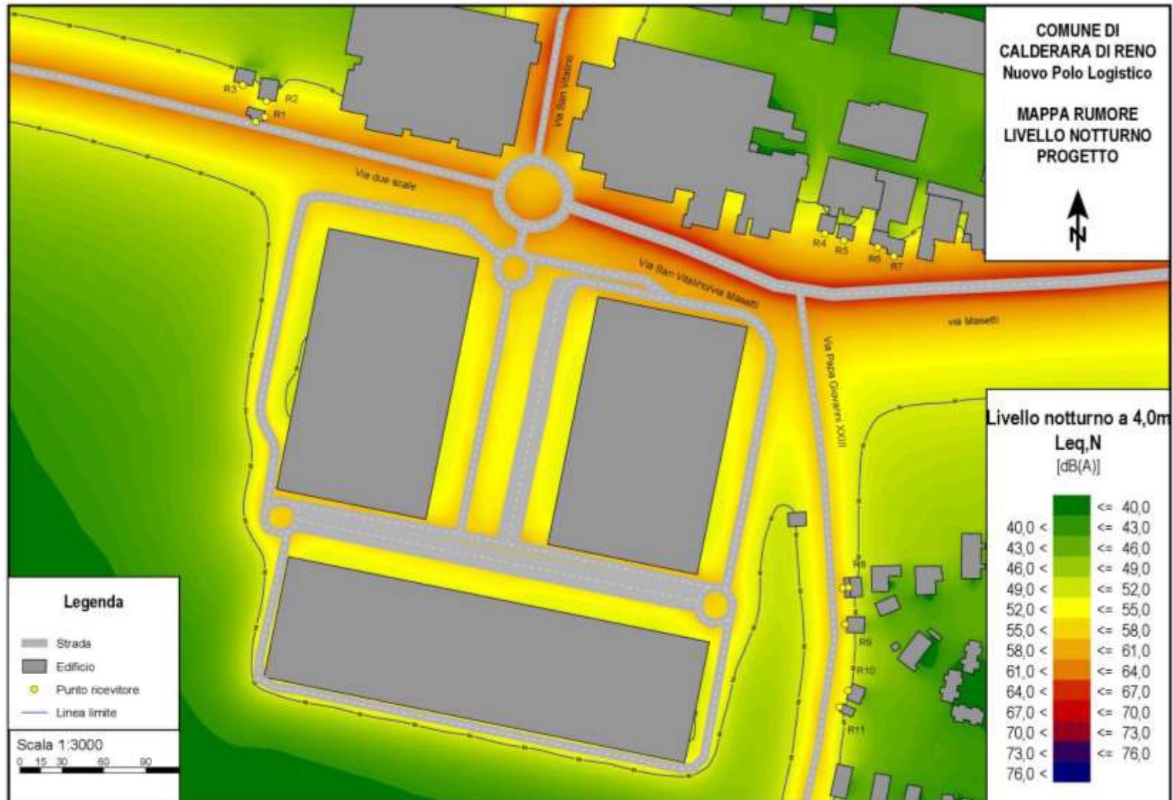
Figura 13b – Mappa acustica di isolivello a 4 m dal piano di campagna – PROGETTO PERIODO NOTTURNO
